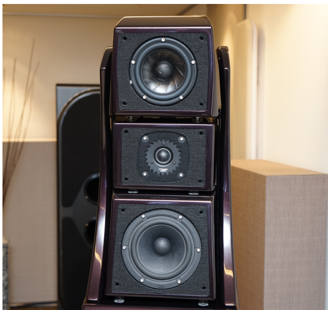
Alexx的中音單體分為5.75吋與7吋，這是為了讓中頻段有最好的表現而設計的，這樣的作法很少看到。
